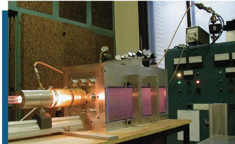
Chambre de stérilisation de 50 litres en régime de post-décharge à 915 MHz (Université de Montréal). Photo : Nicolas Philip
